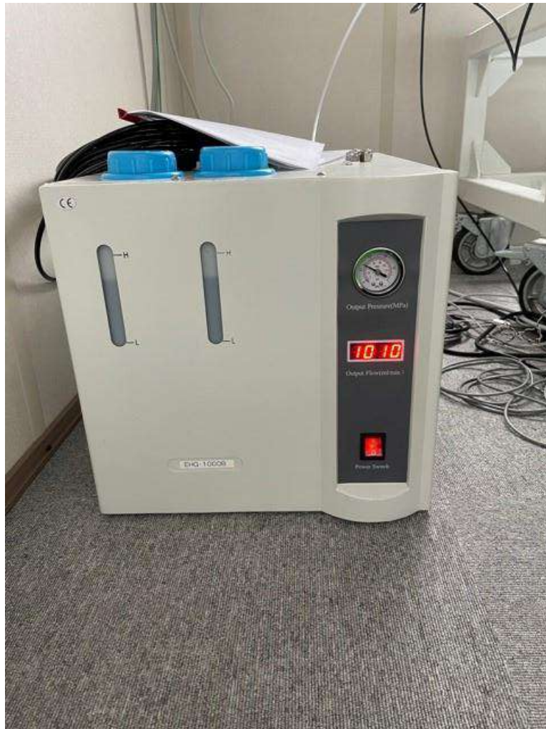
水素発生装置
