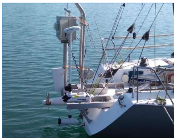
船尾の水流発電装置と電動推進器
